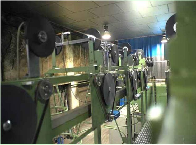
Bremssysteme fuer Einzeldraehte und Anzeige der reellen Arbeitszugkraft
